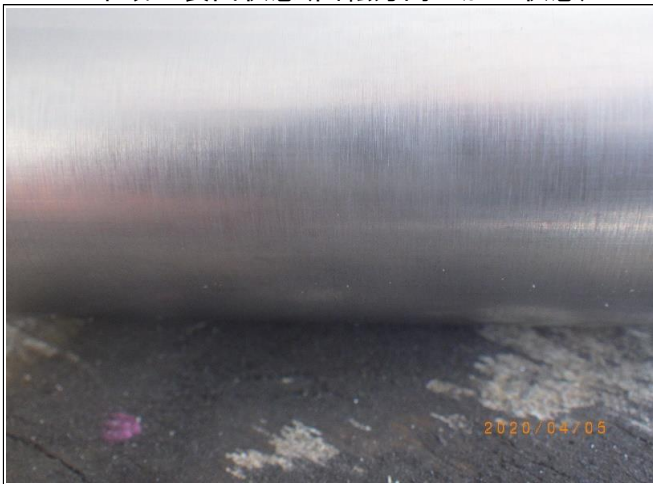
12 正常域の表面状態(回転方向の加工状態)
