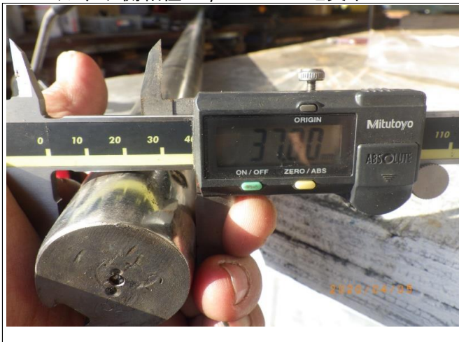
16 カップリング側軸径⇒φ37.20~63と異常
