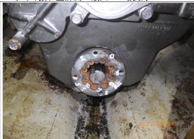
9 マリンギヤ振れ量計測⇒最大0.05略良好
