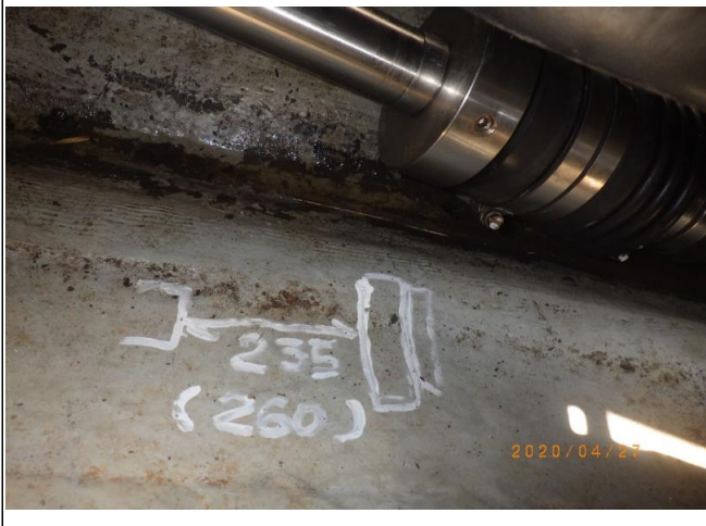
3 PSSシール取付寸法(260-235=25(押ししろ))
