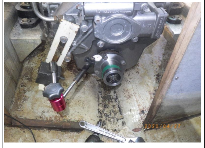
4 カップリング締結後の振れ量計測(0.07mm良好)
